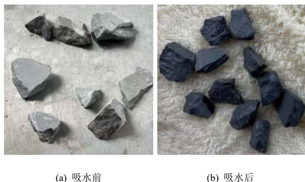
图 5 磷石膏基团粒吸水前后的形态
